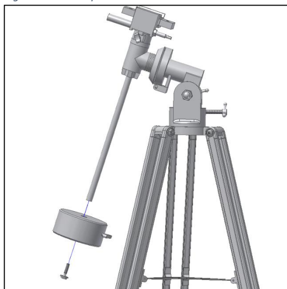
Figure 5. Visser la tige de contrepois. Insérer le contrepois.
